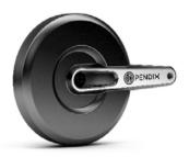
Der Pendix Antrieb ist ein effizienter, leistungsstarker Direktläufer, welcher ohne Getriebe und Freilauf arbeitet. Die Steuerung ist bereits in das smarte Design integriert. Der Pendix-Antrieb sitzt linksseitig am Fahrradirekt am mitgelieferten Messtretlager, welches Ihre eingebrachte Trittkraft ermittelt. Der Motor unterstützt Sie entsprechend der eingestellten Unterstützungsstufe.
