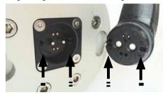
Falls Sie ohne die Power Station laden möchten, achten Sie auf die Steckercodierung. Da der Stecker *magnetisch* ist, hat er den Vorteil, dass sich der Stecker nur an den Akku zieht, wenn Sie ihn richtig herum halten. Die erfolgte Verbindung wird durch Aufleuchten der LED-Anzeige signalisiert.
